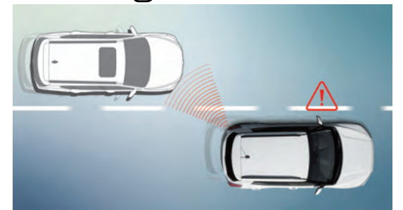
نظام التحذير من اكتشاف النقاط العمياء BSW; Blind Spot-detection Warning
