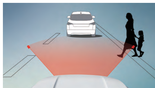
نظام مكابح الطوارئ المستقلة AEB; Autonomous Emergency Braking
