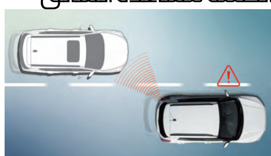
نظام التحذير من اكتشاف النقاط العمياء BSW; Blind Spot-detection Warning
