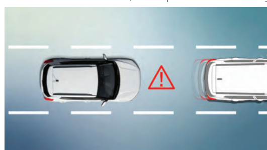
تنبيه بتحريك السيارة التي امامك FVSA; Front Vehicle Start Warning
