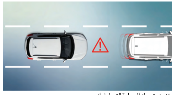
تنبيه بتحريك السيارة التي امامك FVSA; Front Vehicle Start Warning
