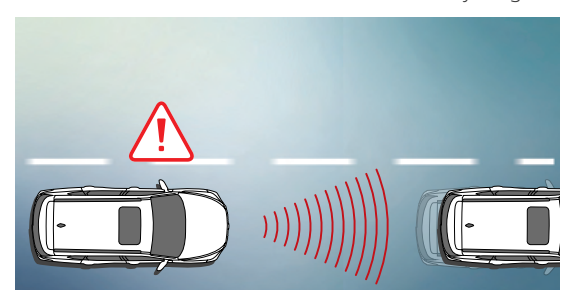
تنبيه بتحريك السيارة التي امامك FVSA; Front Vehicle Start Warning
