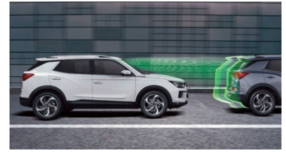
تنبيه بتحريك السيارة التي امامك FVSA; Front Vehicle Start Warning
