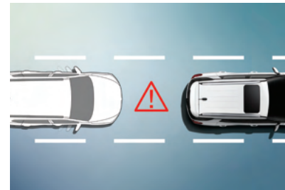
Emergency Stop Signal (ESS) إشارة التوقف في حالات الطوارئ
